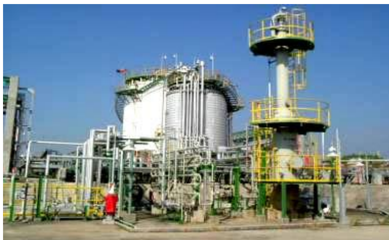
รูปที่ 3-19 แสดงตัวอย่างของ VRU ที่ใช้เทคนิคการดูดกลืน (absorption)
