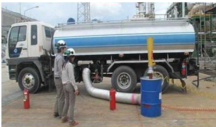
รูปที่ 3-35 การ Drain VOCs จากหอกลิ้นหรือจาก Vessel เข้ารถ Tank Car ที่มา: บริษัท พีทีที โกลบอล เคมิคอล จำกัด (มหาชน)
